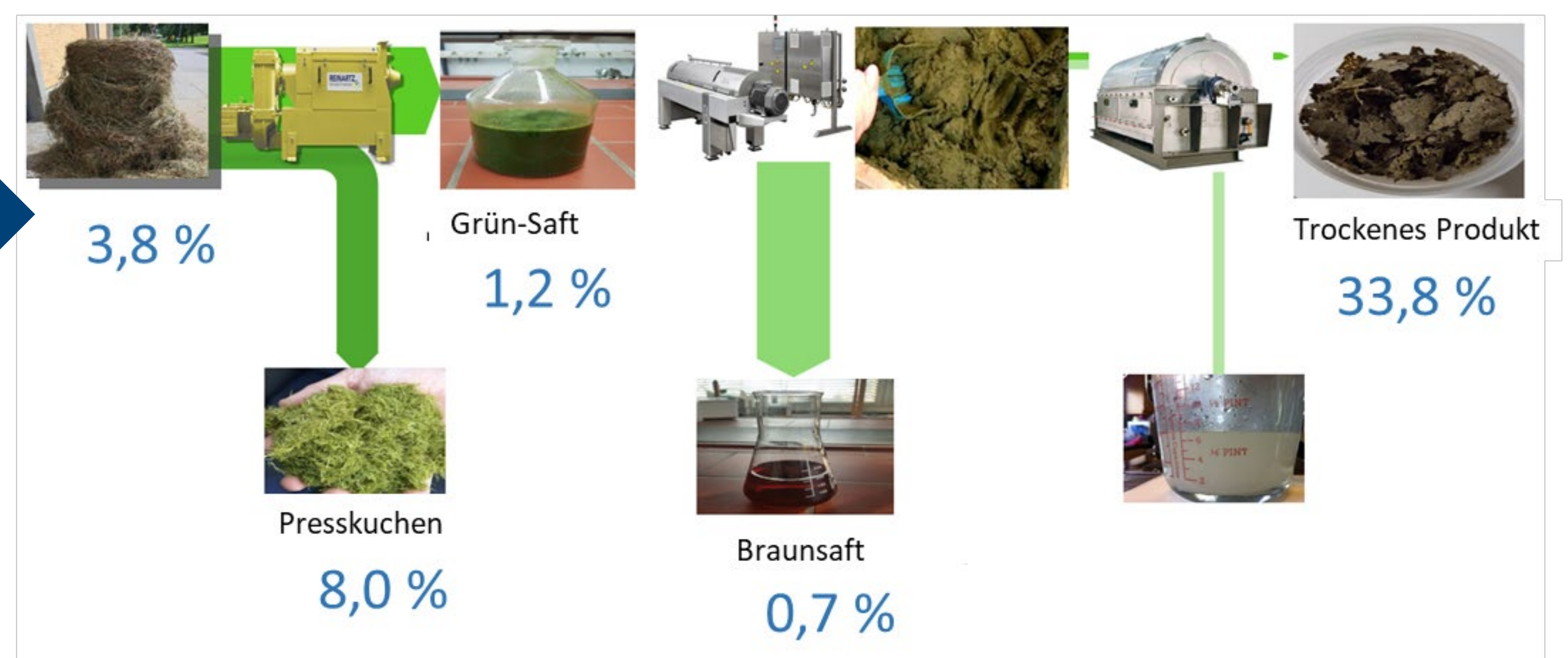
Abb. 3: Verfahrensfließschema mit Massenflüssen (grün) und Rohproteingehalt (blau)
