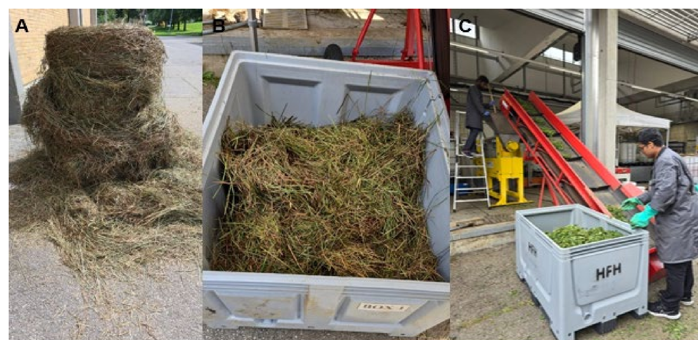
Abb. 2: Nasswiesen-Schnitt und dessen Förderung in die Bioraffinerie.
