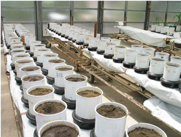
Abbildung 36: Gefäßversuch zum Einfluss von Schwefel auf Bodeneigenschaften.
