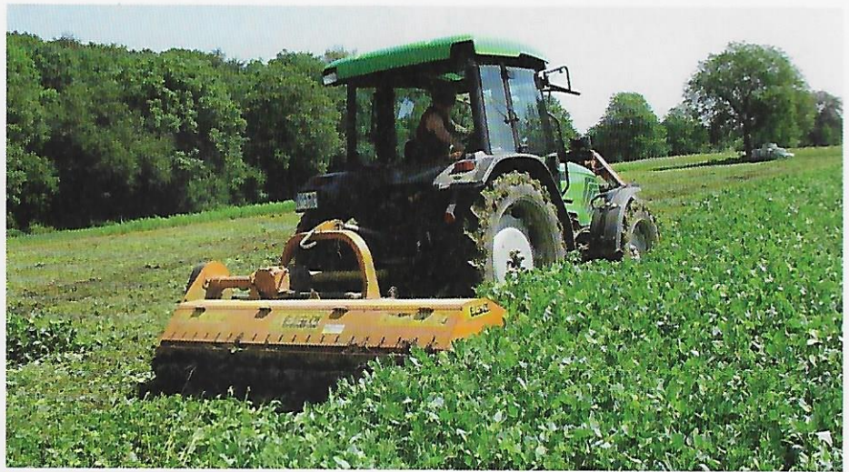
Bild 4: Mulchen der Ackerbohrendichtsaaat. Mittlerweile hat der Betrieb einen Frontmulcher, mit dem lange Pflanzenreste in der Schlepperspur vermieden werden.
